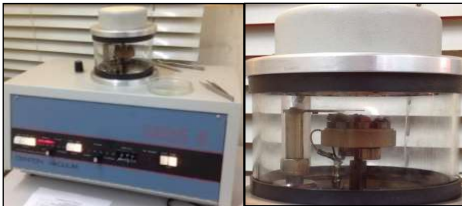
Figura 89. Metalizador: Equipamento para a preparação das amostras. Amostras metalizadas (C, V, Y, A, X, F e I) prontas para a análise por MEV-EDS.
