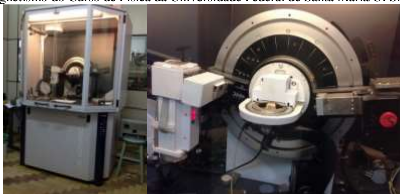
Figura 87. Equipamento utilizado na primeira fase de análises químicas por Difractometria de Raios-X. Laboratório de Magnetismo do Curso de Física da Universidade Federal de Santa Maria/UFSM.
