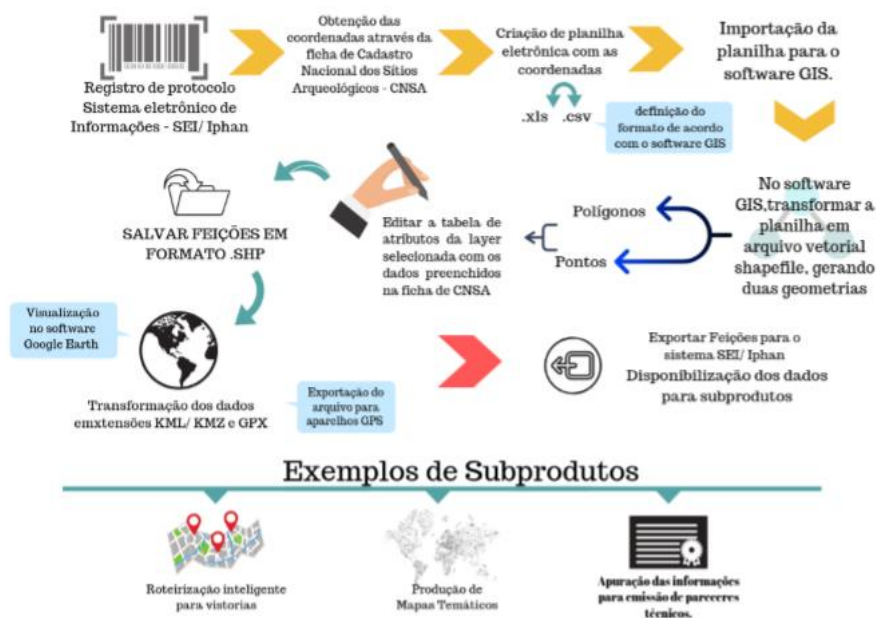
Figura 16 - Representação dos procedimentos do cadastro de Sítios Arqueológicos na base de dados georreferenciada do IPHAN-ES.
