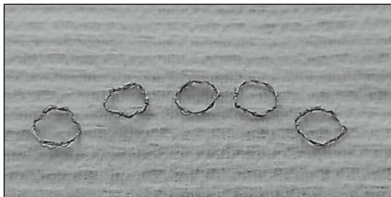
Figura 15 - Monitores de Ni-Cr utilizados para medir o fluxo de nêutrons térmicos
