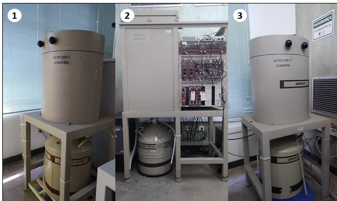
Figura 16 - Espectrômetros gama de alta resolução. 1. Detector modelo GEM45190, com eficiência de 45 %. 2. Detector modelo GMX50220, com eficiência de 50 %. 3. Detector modelo GEM50P4-83, com eficiência de 50 %
