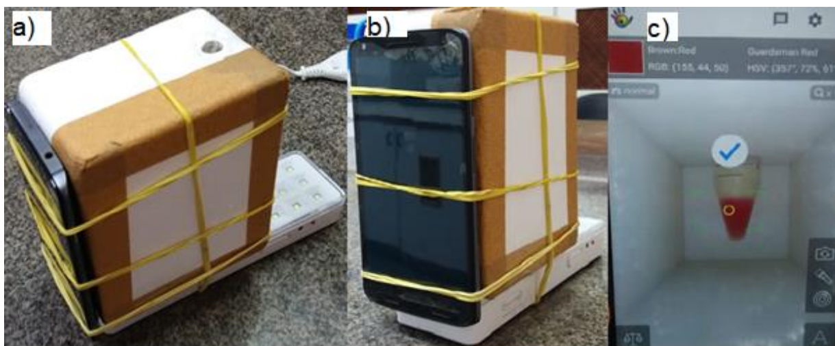
Figura 6 - Câmara empregada nas medidas RGB, visão (a) superior com abertura para tubo; (b) frontal e lateral e (c) interior pela câmera do smartphone
