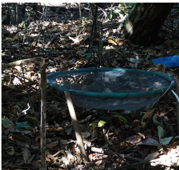
Figura 12 - Coletor circular utilizado nas coletas de amostras de serapilheira
