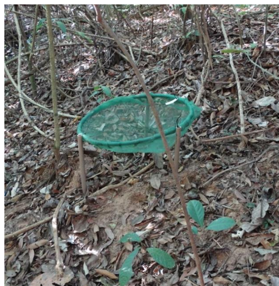
Figura 12 - Coletor circular utilizado nas coletas de amostras de serapilheira
