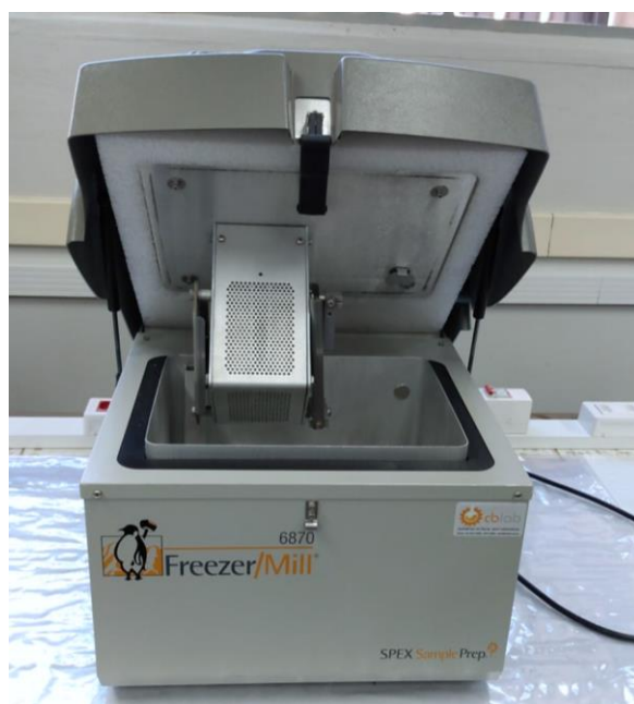
Figura 5.4 - Moinho criogênico Freezer Mill, modelo 6870 do laboratório de Química Analítica do Centro de Energia Nuclear na Agricultura da Universidade de São Paulo (CENA/USP).
