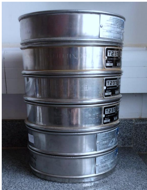
Figura 4.6 - Esquema empilhado de peneiras utilizado para a separação granulométrica das amostras de microplásticos.
