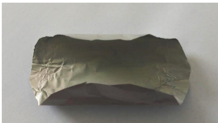
Figura 4.8 - Barquinha confeccionada em folha alumínio (aproximadamente 10 cm de comprimento) para pesagem das categorias por amostra.
