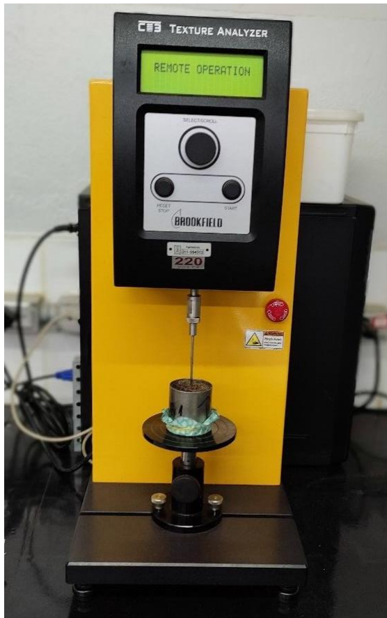
Figura 20 - Penetrômetro eletrônico do Laboratório de Física do Solo da ESALQ, utilizado nas determinações de resistência do solo a penetração, ao analisar uma amostra da área de BD1
