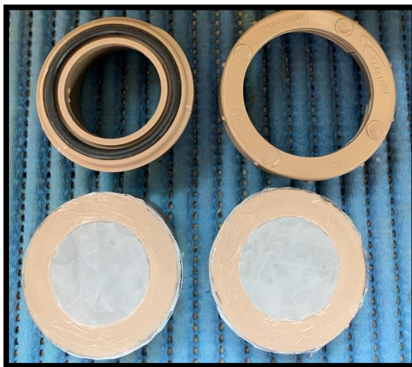
Figura 21 - Suporte de polietileno com filtro de 6mm para clarificação das amostras.
