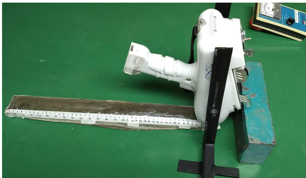
Figura 20 - Conjunto de suporte mais o pED-FRX sobre o testemunho recoberto pelo filme fino. Tijolo de chumbo disposto na frente do equipamento para proteção radiológica.
