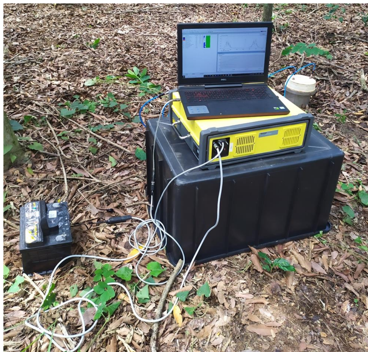
Figura suplementar S8. Equipamento utilizado para medir os fluxos de CO 2 e CH 4 do solo em campo. O dispositivo amarelo corresponde ao analisador Gaset DX4015 GHG alimentado por uma fonte de bateria (esquerda) e conectado a uma câmara estática (direita) em circulação de ar fechada contínua e incubação.
