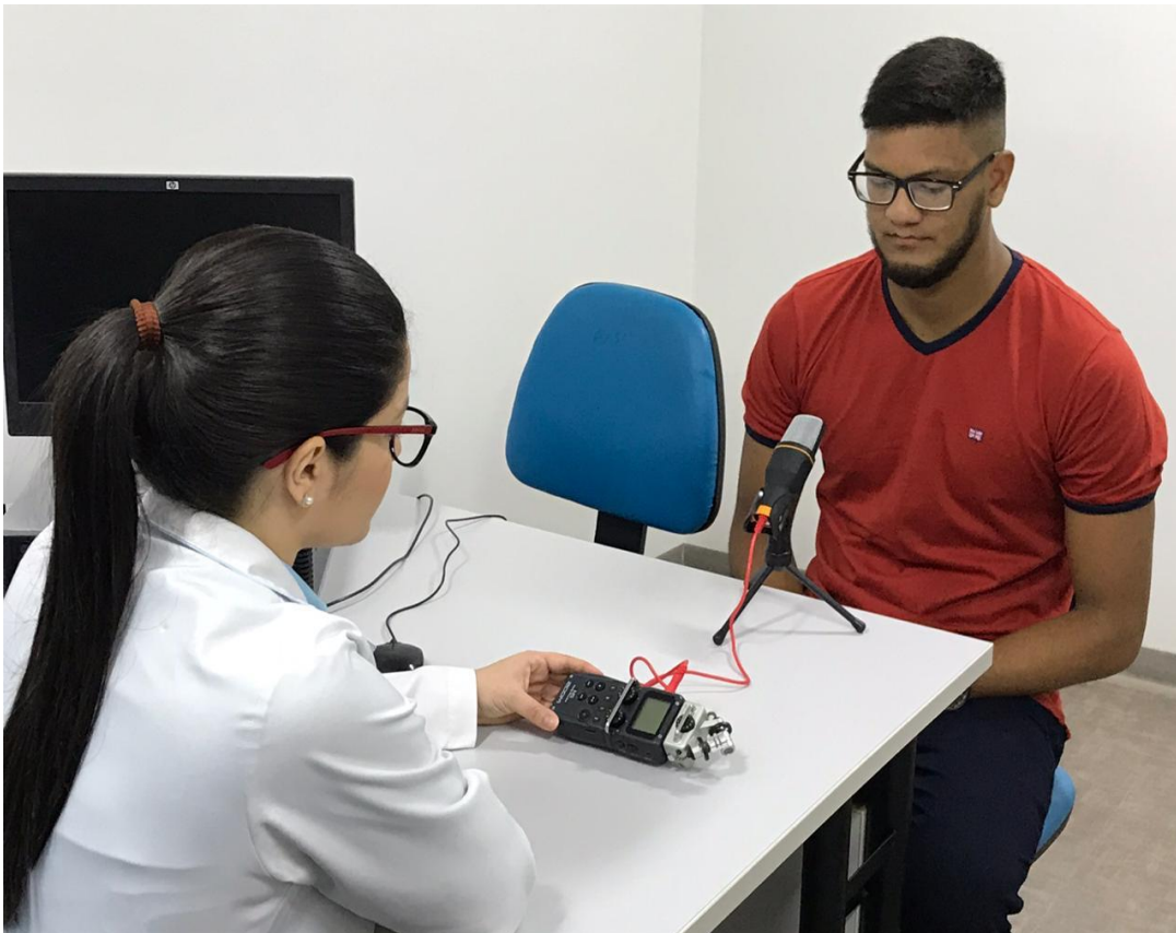
Figura 1. Equipamento utilizado para a captação das amostras de fala. Gravador H-5 ZOOM e microfone bidirecional AKG.
