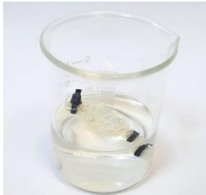
Figura 12 – Sistema utilizado para a determinação do perfil de liberação de artepelin C e formononetina a partir das nanocápsulas contendo os extratos de própolis verde e vermelha brasileira (NC-PV e NC-PVB)
