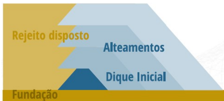
Figura 5 - Barragem alteada por linha de centro
