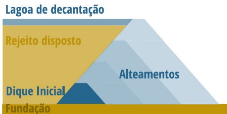
Figura 4 - Barragem alteada a jusante
