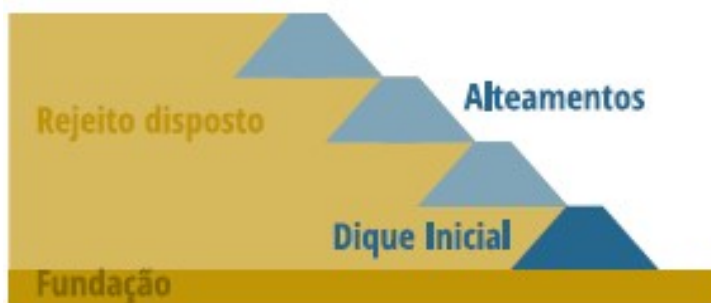
Figura 3 - Barragem alteada a montante
