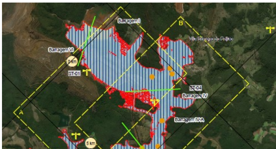
Figura 48 - Mapa de inundação após o rompimento das barragens I, IV, IV-A e VI
