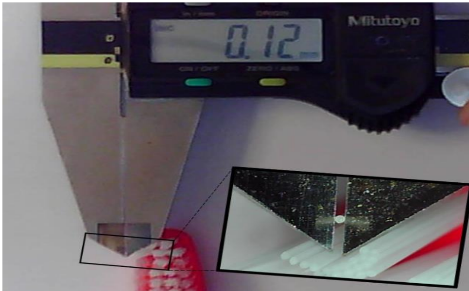
Figura 18 - Medida do diâmetro de uma cerda de escova dental manual em destaque.
