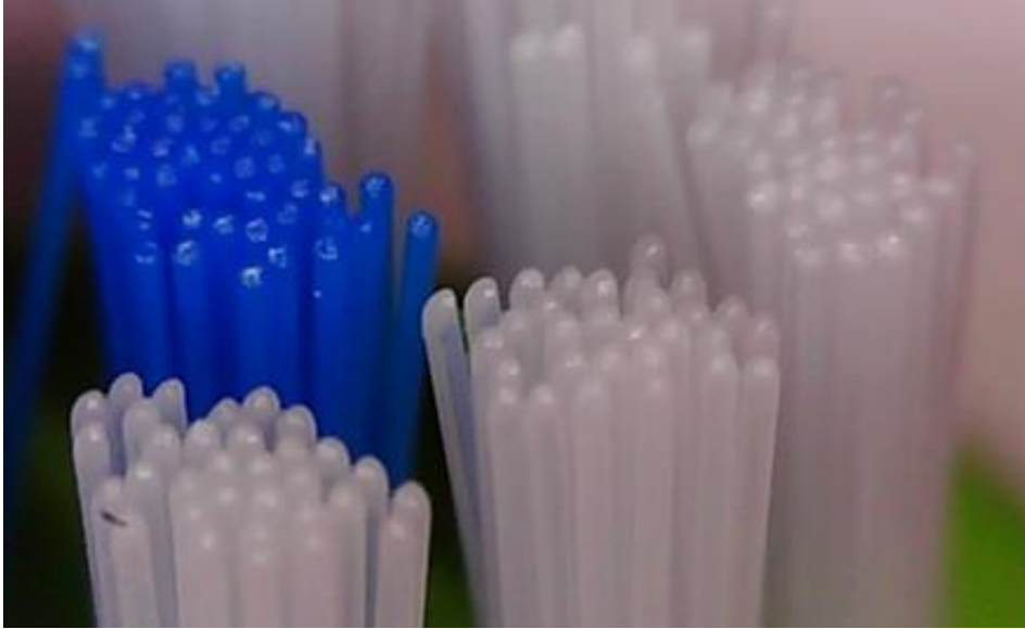
Figura 10 - Pontas (extremidades) de cerdas arredondadas de escovas dentais manuais.
