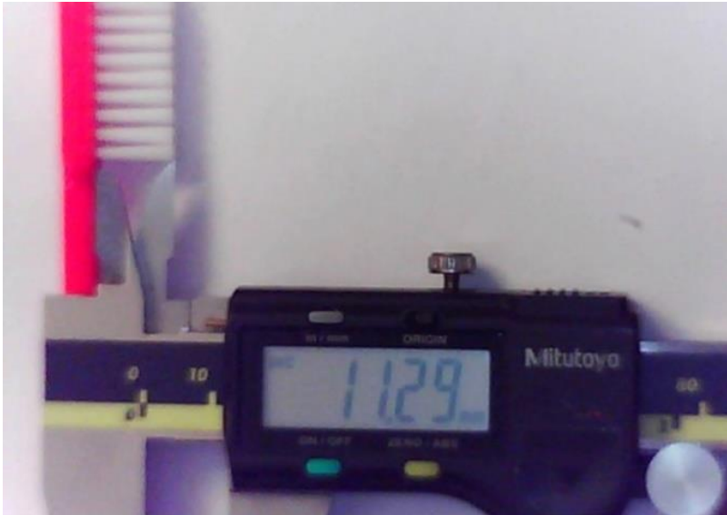
Figura 16 - Medida da altura das cerdas, utilizando Paquímetro digital Mitutoyo .
