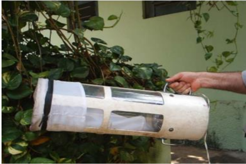
Figura 10. Modelo de aspirador para coleta de mosquitos adultos Fonte: FÁVARO,2006
