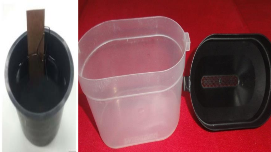
Figura 16 A: Ovitrapa com palheta de Eucatex® para coleta dos ovos. B: Larvitrampa WS Fonte: Dissertação: OLIVEIRA, A. A. Fundação O. Cruz. 2017.
