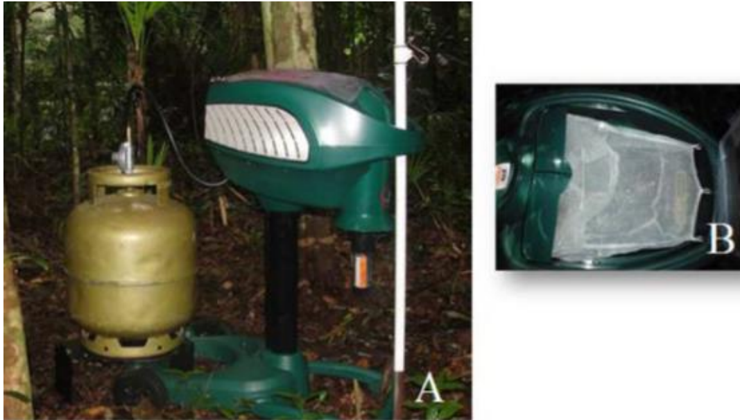
Figura 7. A: Armadilha Mosquito Magnet Independence: Compartimento de aprisionamento dos insetos. Captura de adultos com Mosquito Magnet Independence iscada com CO 2 e Lurex3, realizada na Estação experimental de Pariquera-Açu, Vale do Ribeira, São Paulo. Fonte: Dissertação: CHAVES, L. S. M. USP. 2012.
