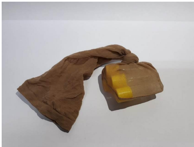
Figura 15. Tubos criogênicos em meia de nylon. Imagem: Laboratório de Identificação e Pesquisa em Fauna Sinantrópica (LABFAUNA/DVS/ COVISA/SMS/PMSP).
