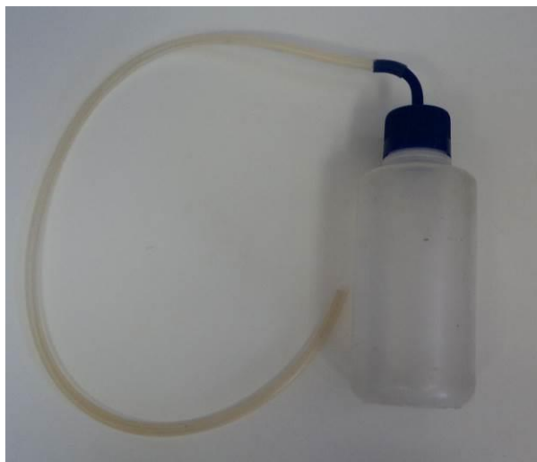
Figura 9. Instrumento utilizado para a coleta das formas imaturas de mosquitos (Diptera: Culicidae). Pisseta de sucção. Imagem: Laboratório de Identificação e Pesquisa em Fauna Sinantrópica (LABFAUNA/DVS/SMS).
