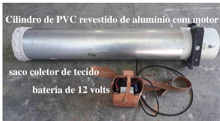
Figura 6. Aspirador de Nasci. Imagem: Laboratório de Identificação e Pesquisa em Fauna Sinantrópica (LABFAUNA/DVS/ COVISA/SMS/PMSP).
