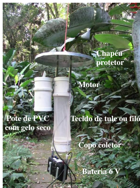
Figura 5. Armadilha CDC. Imagem: Laboratório de Identificação e Pesquisa em Fauna Sinantrópica (LABFAUNA/DVS/COVISA/SMS/PMSP).
