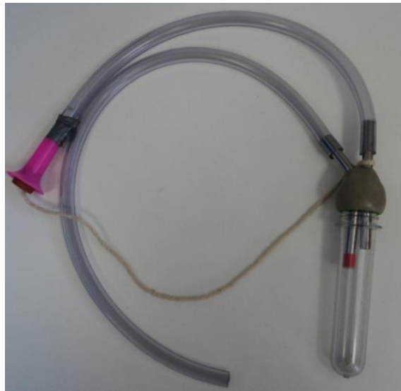
Figura 2. Aspirador de sucção oral. Imagens: Laboratório de Identificação e Pesquisa em Fauna Sinantrópica (LABFAUNA/DVS/COVISA/SMS/MSP).
