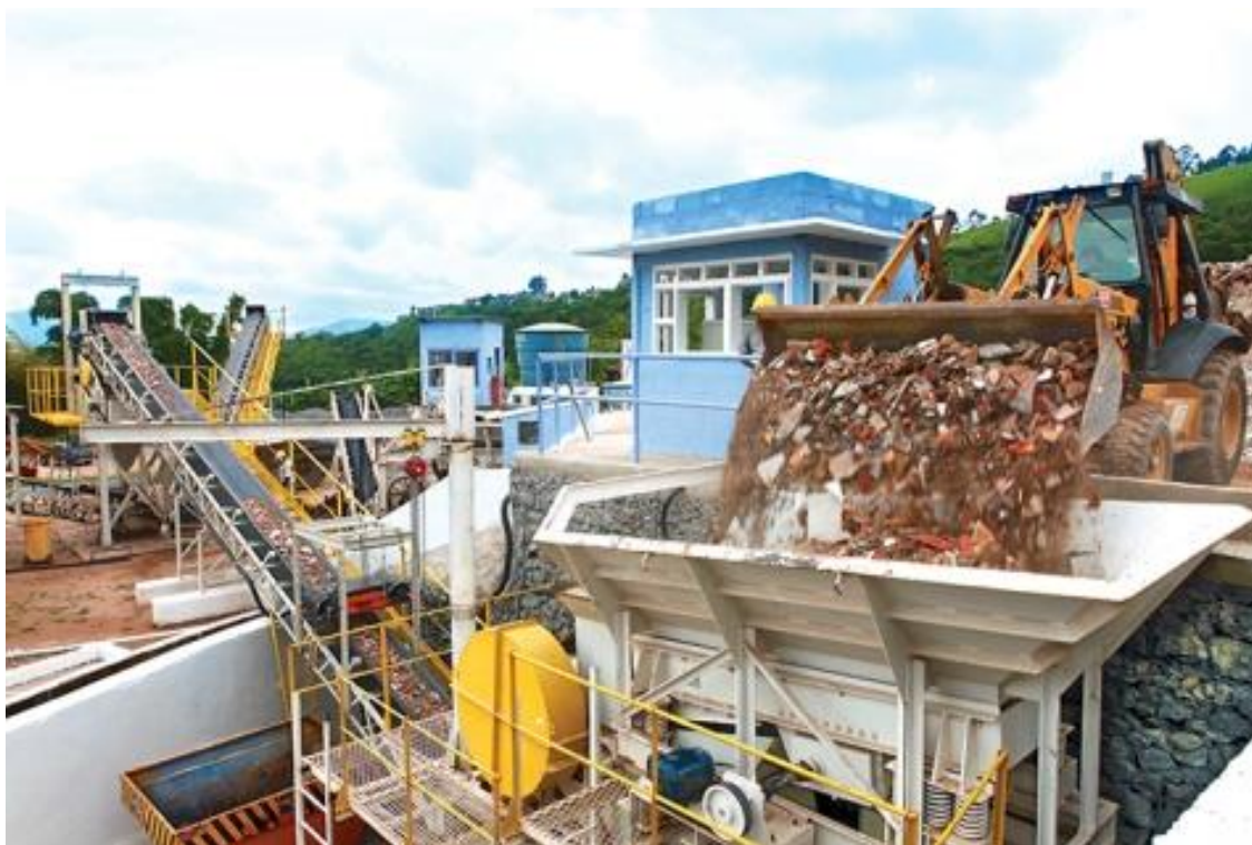
Figura 6 - Equipamentos constituintes de uma usina de reciclagem
