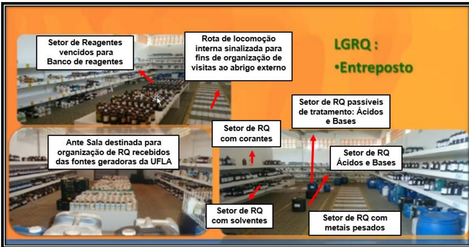
Figura 41: Abrigo externo da UFLA: Procedimento de segregação de RQ
