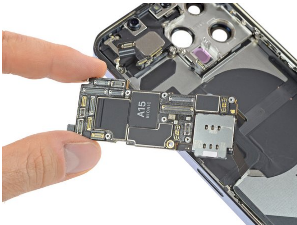
Figura 31 - Placa de circuito de um iPhone 13 PRO
