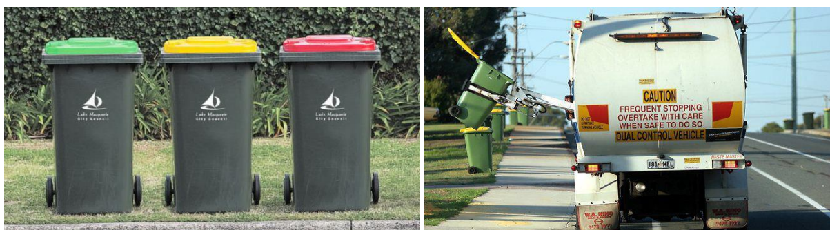
Figura 13: Exemplo de containerização de duas rodas e coleta mecanizada de carga lateral aplicada em Moreland, Austrália.
