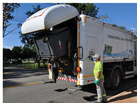
Higienização mecanizada de contêineres
