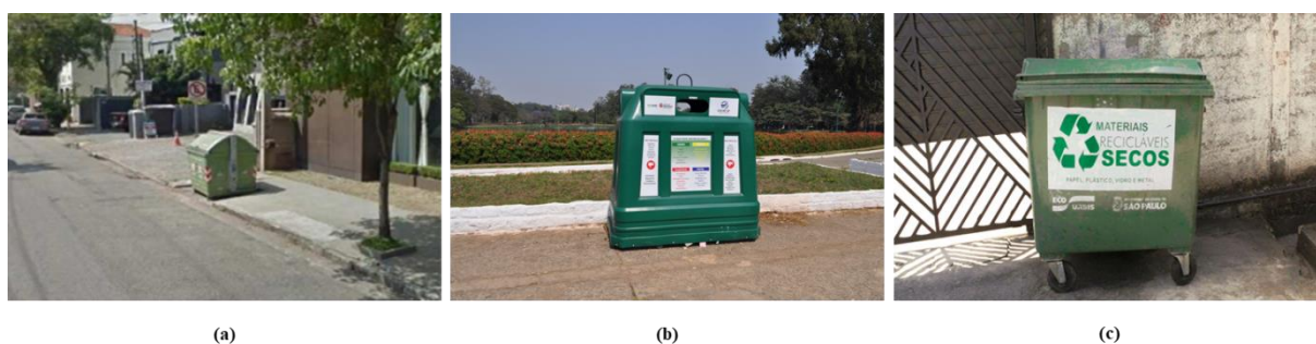
Figura 15: Contêineres implantados em São Paulo: a) contêiner estacionário de carga lateral, b) contêiner estacionário de carga vertical, c) contêiner móvel de carga traseira.
