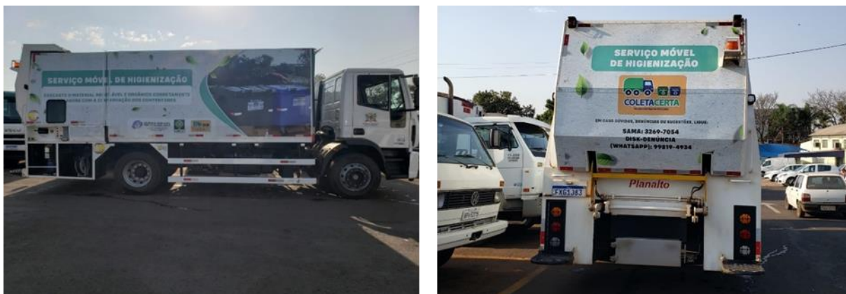
Figura 25: Veículos higienizadores de contentores de carga traseira.
