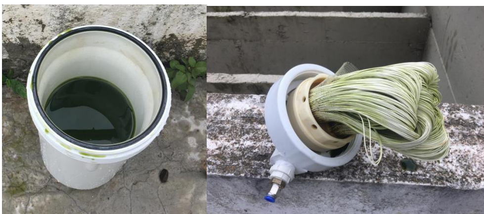
Figura 48. Membrana de UF após filtração com grande quantidade de algas retidas
