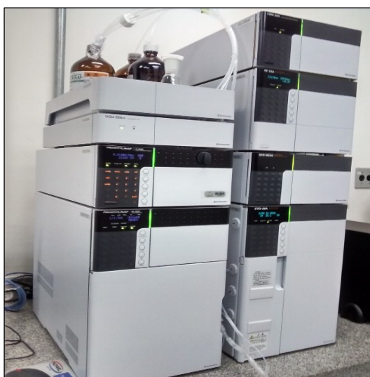
Figura 1 - Cromatógrafo a líquido de ultra eficiência (Shimadzu) usado na análise de HPAs
