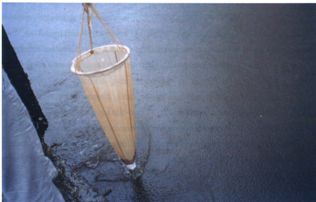
FIGURA 5 – Rede de coleta de plâncton utilizada neste estudo. Área de influência da BTS, Bahia, Brasil, 2000-2002.
