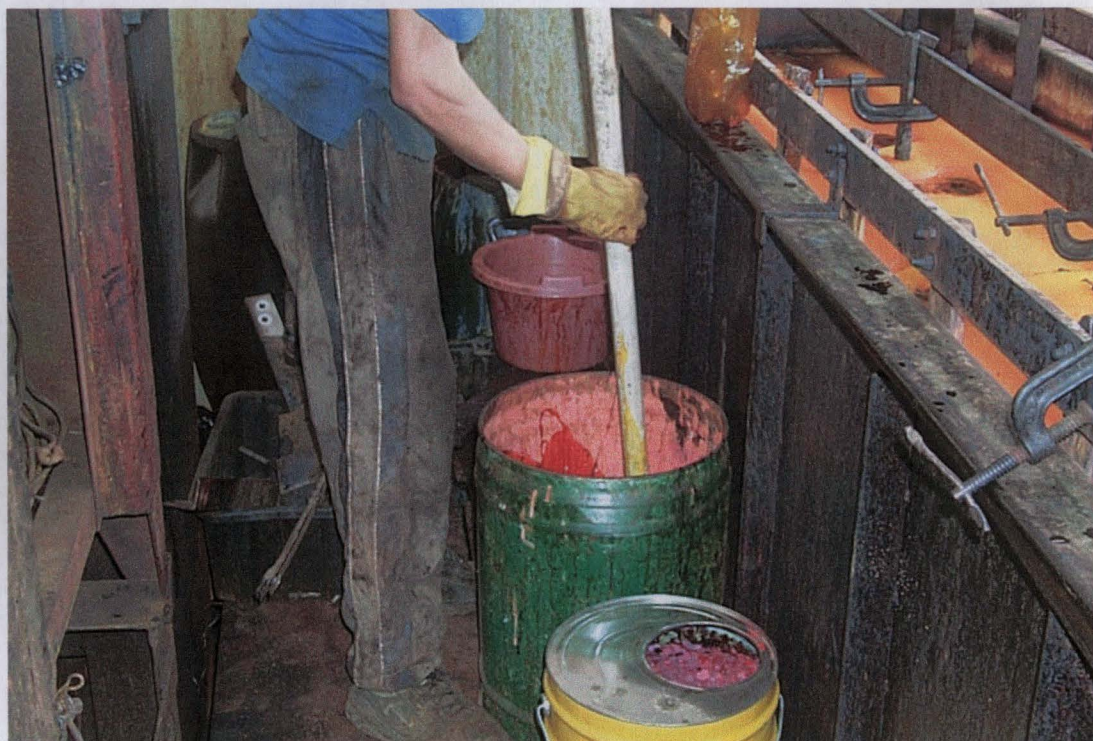
Figura 6: Preparação do solução eletrolítica de Cr VI para reforçar o banho na empresa E_{01}
