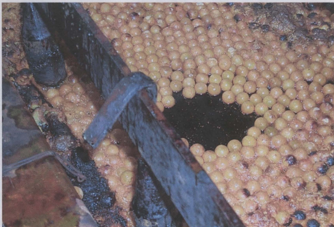
Figura 17: Foto de tanque de um banho eletrolítico de cromo hexavalente com esferas plásticas na empresa E 02
