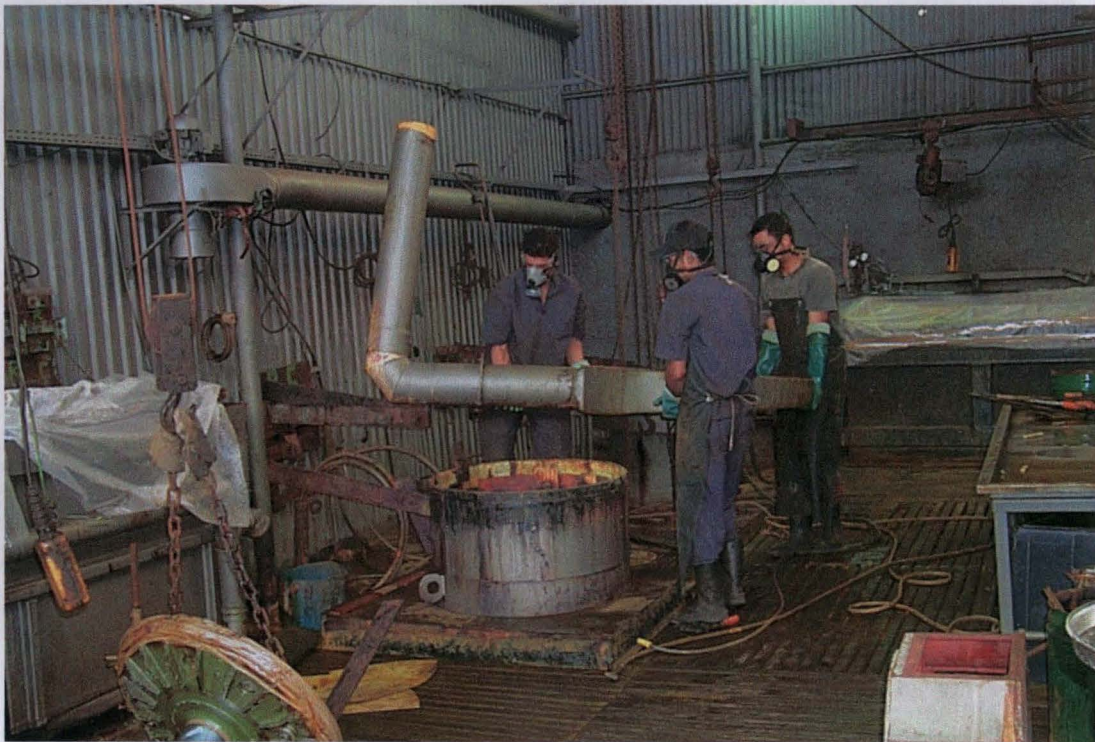
Figura 65: Foto mostra trabalhadores retirando o sistema de ventilação para a colocação uma peça grande dentro do tanque cilíndrico de eletrodeposição na empresa E 10
