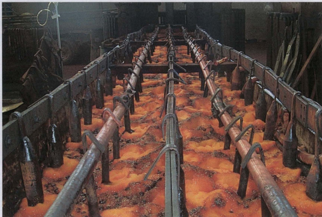
Figura 16: Banho eletrolítico de cromo hexavalente com espuma tensoativa na empresa E 02
