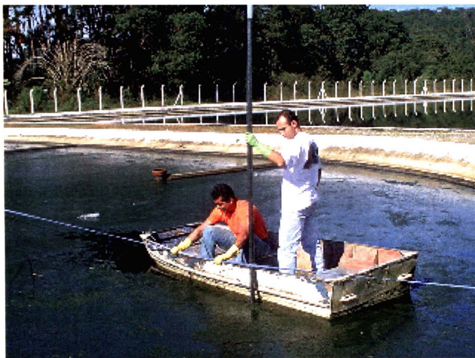
Figura 6.20 Retirada de amostra de lodo.
