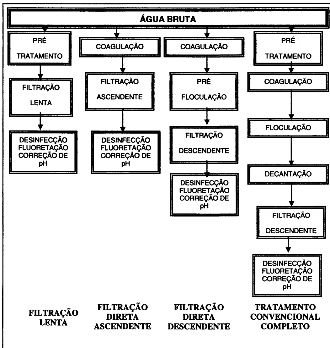
Figura 3.8 Diversos processos utilizados no tratamento de água bruta, comparando os tipos de filtração.
