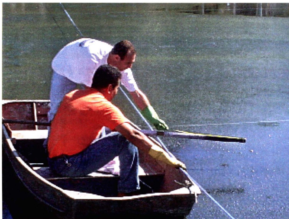
Figura 6.19 Medição da espessura da camada de lodo.
