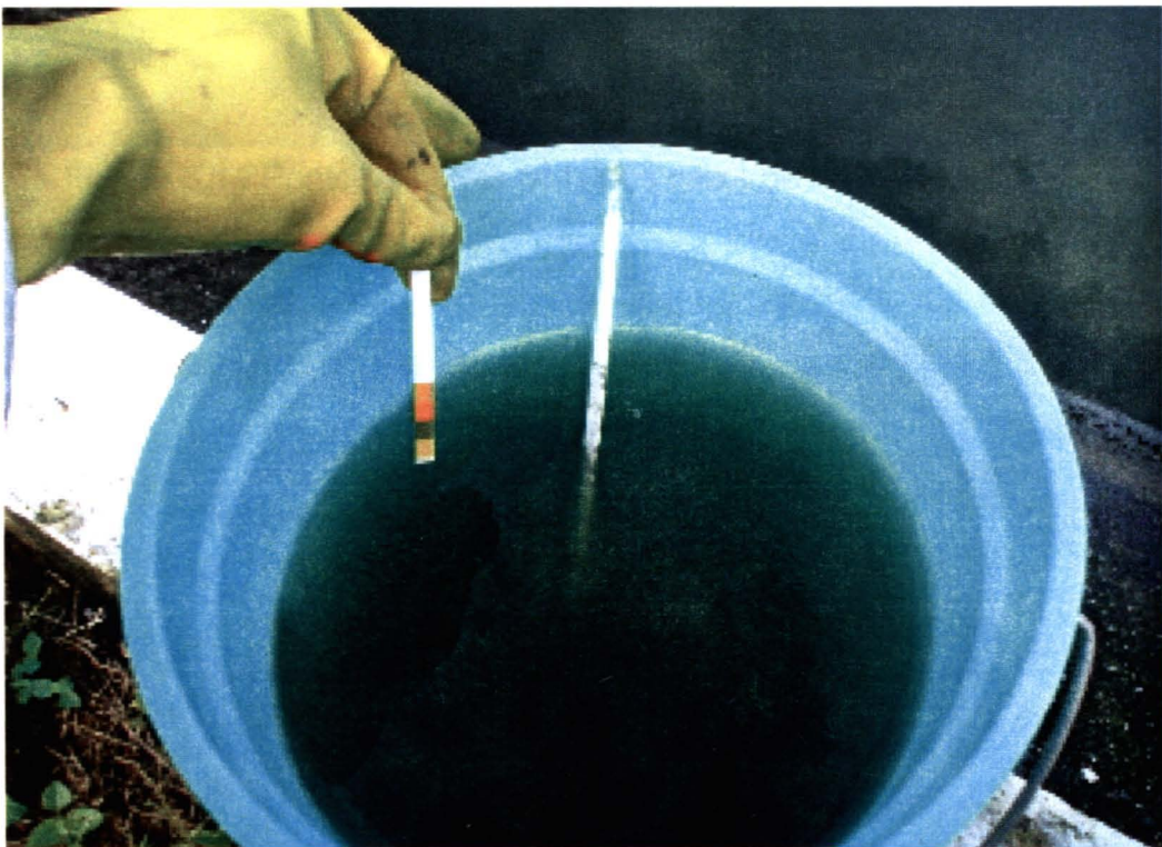
Figura 6.13 Coleta de esgoto utilizando balde e corda
