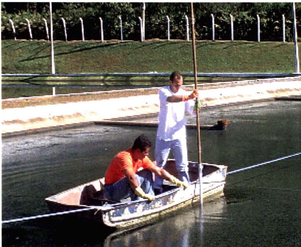
Figura 6.18 Ponto de amostragem da espessura do lodo.
