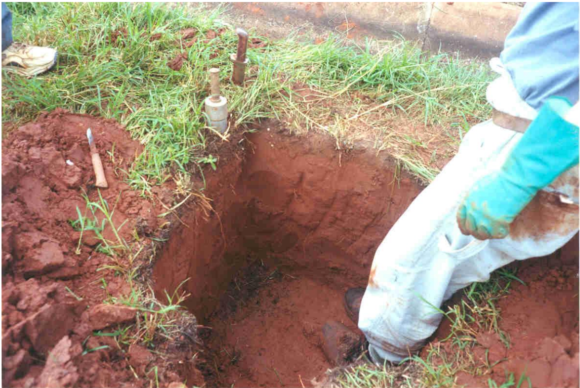
Figura 72 - Detalhe da coleta de amostras com anéis volumétricos.
