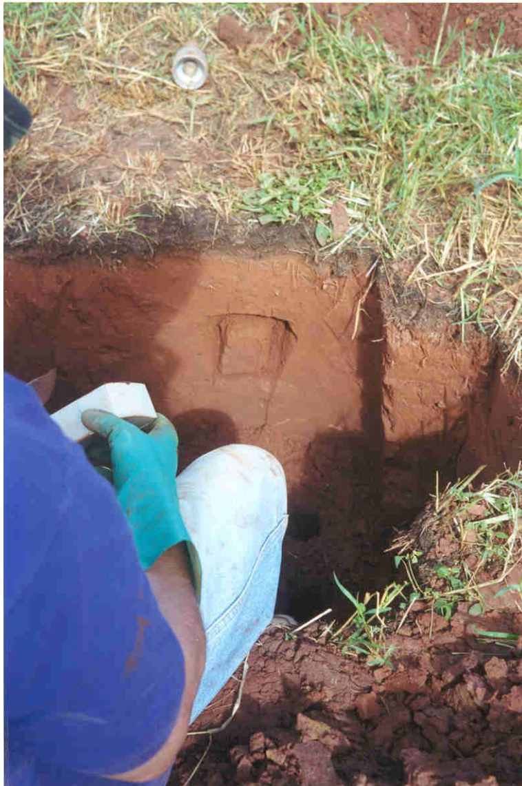
Figura 73 - Detalhe da coleta de amostras indeformadas para confecção de lâminas delgadas dentro do módulo de disposição IV.
