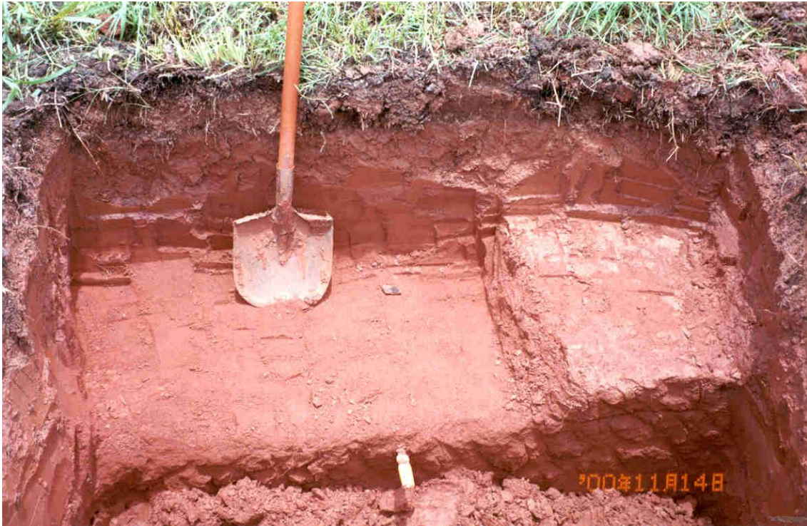
Figura 74 - Detalhe da abertura de trincheira para instalação de infiltrômetro multidisco.
