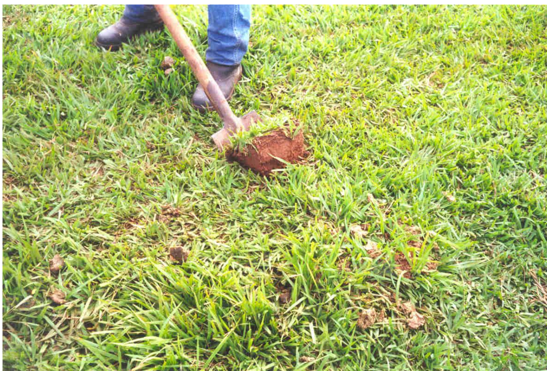
Figura 113 - Retirada de amostras na superfície dos pontos de controle e testemunha.
