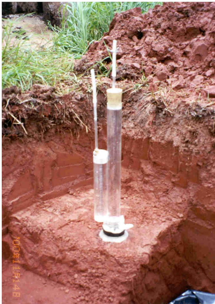
Figura 75 - Infiltrômetro multidisco instalado para medição da condutividade hidráulica.
