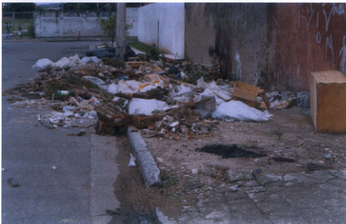
Figura 14 – Disposição irregular de RCD e outros tipos de resíduos.
