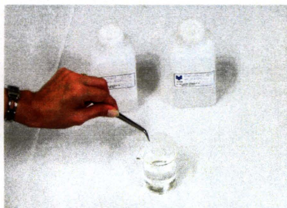
Figura 6. Impregnação dos discos soluções ácida e básica.
