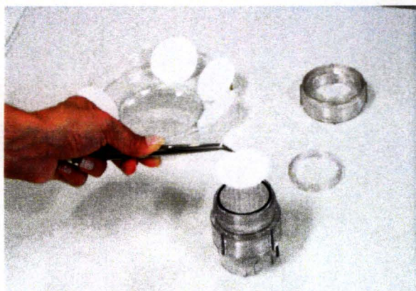
Figura 9. Montagem do amostrador colocando-se o filtro de ácido cítrico.
