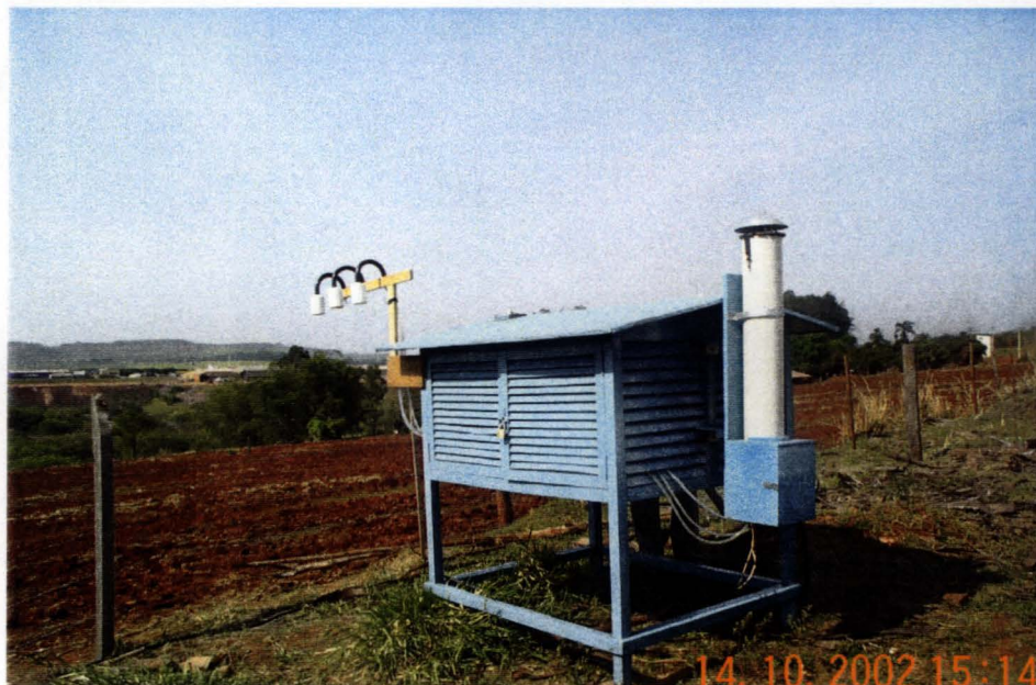
Figura 22. Vista geral dos 3 amostradores de filtro duplo (lado esquerdo da foto) e dos amostradores do tubo de difusão (localizados dentro da proteção de PVC) utilizados na 2ª e 3ª campanhas de amostragem.
