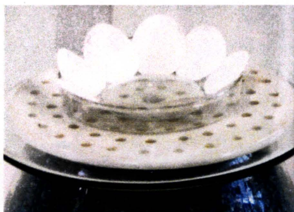
Figura 7. Secagem dos discos impregnados em dessecador.
