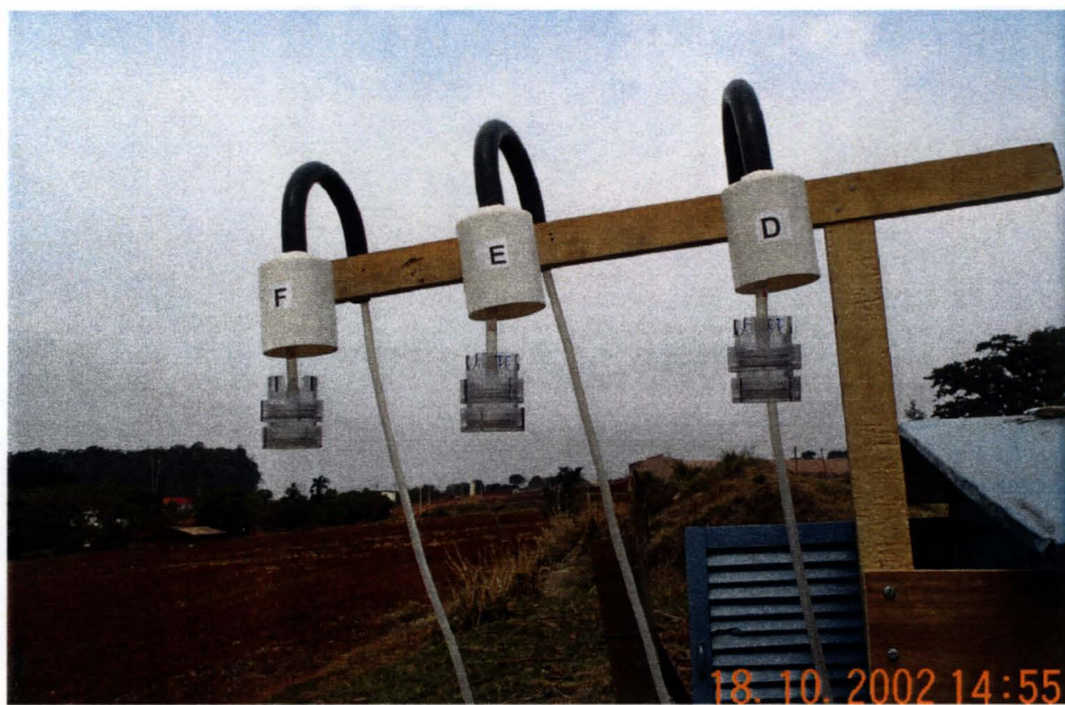
Figura 25. Vista dos 3 amostradores de fita duplo em paralelo.
