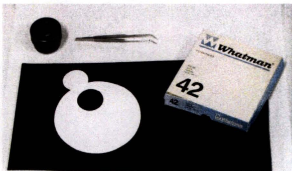
Figura 5. Corte do papel Whatman nº 42 em discos de 47 mm de diâmetro.
