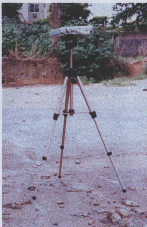
Figura 11. Equipamento posicionado a 1 m de altura em relação à superfície do solo para medidas de radiação gama ambiental.
