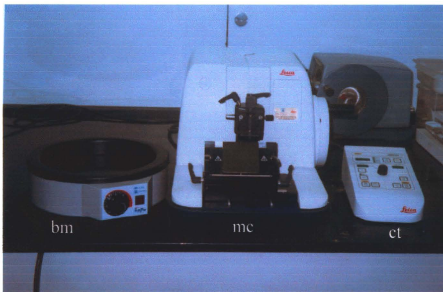
Figura 4 – Foto dos equipamentos utilizados nos cortes histológicos. bm: banho Maria. mc: micrótomo. ct: painel de controle.
