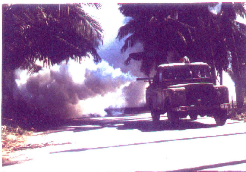
FIGURA 13: Termonebulizador veicular PulsFOG K-3 ECR Fonte:Pulsfog Pulverizadores Ltda. Folder comercial. Diadema (SP); S.D.
