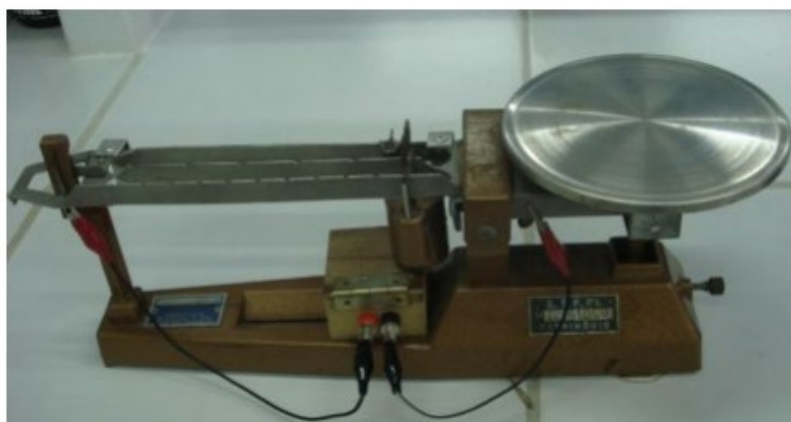
Figura 6: Ligações elétricas para a sinalização sonora de fim de pesagem.
