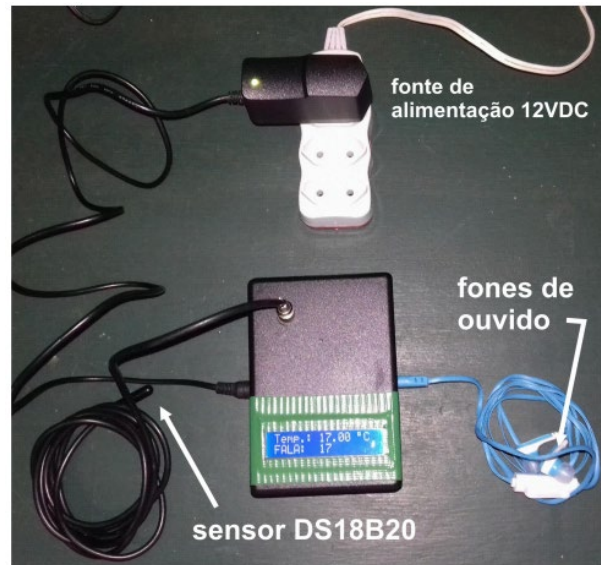
Figura 8: Montagem do circuito do audiotermômetro.
