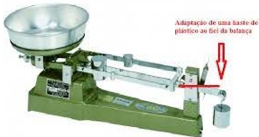
Figura 3 Balança semi-analítica adaptada para deficientes visuais
