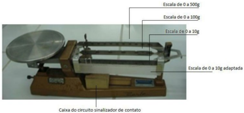
Figura 4: Balança de escala tríplice adaptada para uso por deficientes visuais.
