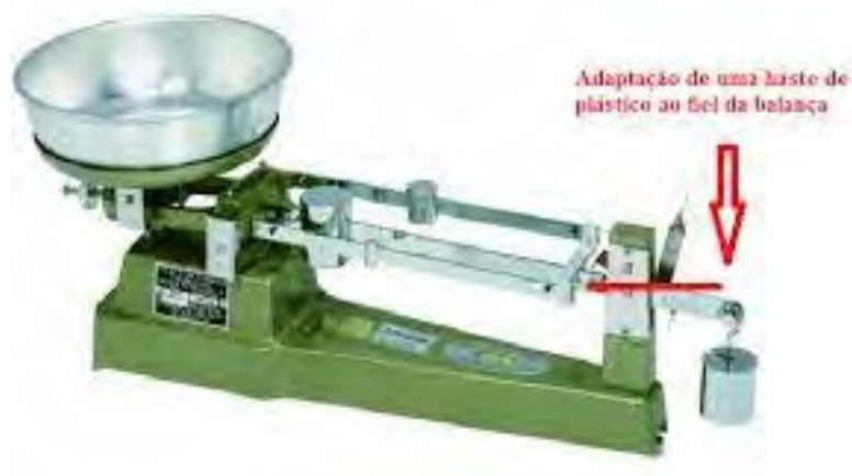
Figura 3 Balança semi-analítica adaptada para deficientes visuais
