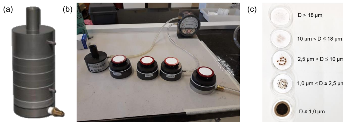
Figura 12 - Fotos do amostrador MOUDI (a) montado e (b) desmontado com os filtros antes da amostragem. (c) Filtros após a amostragem
