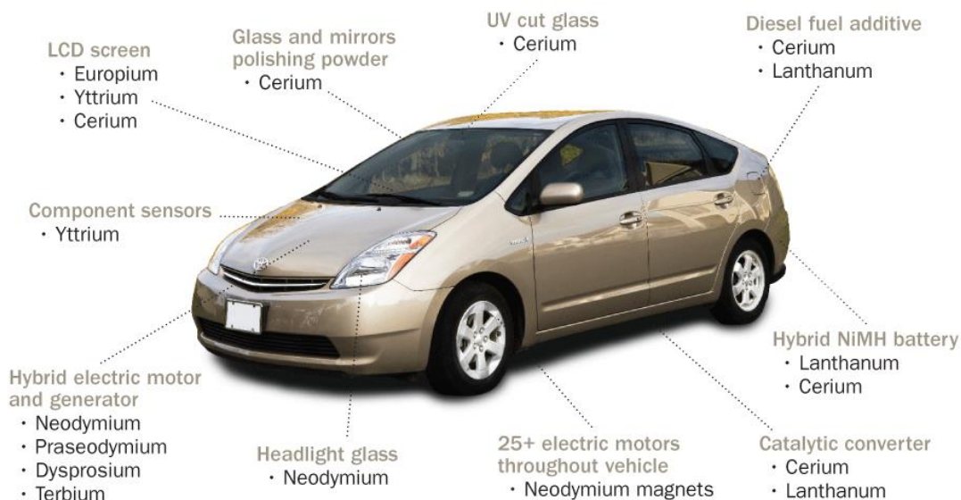
Figura 3. Terras raras empregados em diferentes componentes de Veículo Híbrido Elétrico Prius TM
