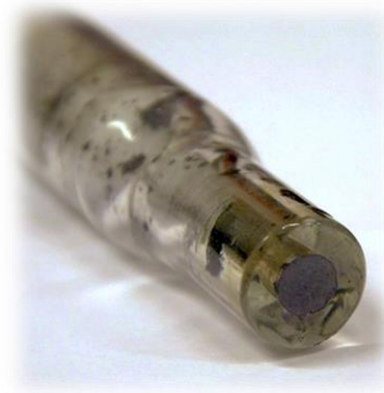
Figura 13. Imagem representativa de um eletrodo de pasta de carbono.
