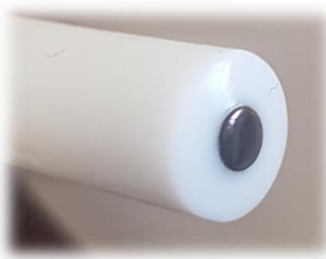
Figura 12. Imagem representativa de um eletrodo de carbono vítreo.
