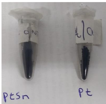
Figura 11 - Eletrocatalisadores metálicos obtidos. Da esquerda para a direita MWCNTs-Pt 75 Sn 25 , e MWCNTs-Pt.
