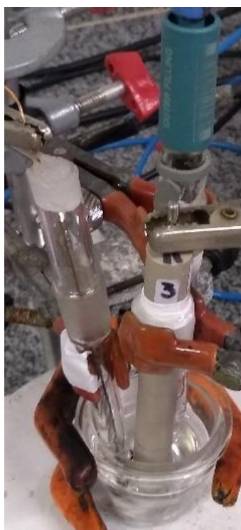
Figura 13 - Célula eletroquímica utilizada nas análises de voltametria cíclica e cronoamperometria.
