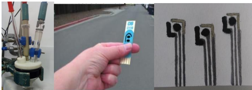
Figura 7: Sistema montado para a célula eletroquímica contendo os 3 eletrodos (própria autora); Eletrodo impresso comercial (fonte: site da empresa comercializadora Metrohm) Desenhos realizados a mão com lápis 5B em papel sulfite. (própria autora)
