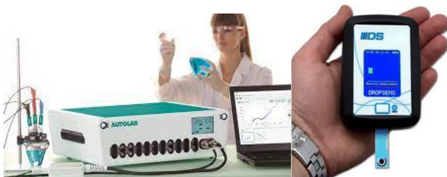
Figura 8: Potenciostato de bancada, usado para medidas eletroquímicas e o potenciostato portátil, com um eletrodo impresso comercial conectado. (Fonte: site da empresa comercializadora Metrohm)
