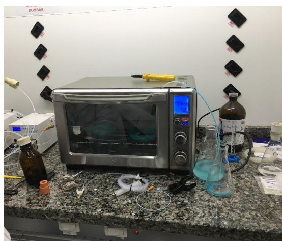
Figura 30. (a) Esquema, (b) Fotografia do processo de reação por fluxo contínuo para síntese do MOF HKUST-1. 145
