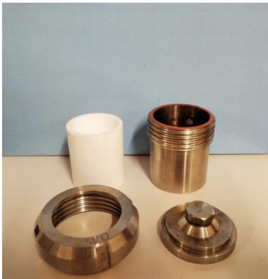
Figura 13. Reator hidrotermal com autoclave de Teflon® utilizado na síntese hidrotermal.
