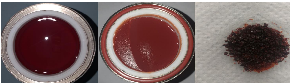
Figura 56. Síntese FeTMA antes (esquerda) e depois (centro e direita) mostrando o produto formado no pós-síntese, e o mesmo após a lavagem e secagem.
