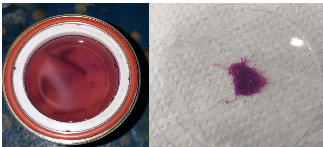
Figura 80. Imagem do pós-síntese mostrando o sólido violeta formado e o mesmo separado após lavagem e secagem.
