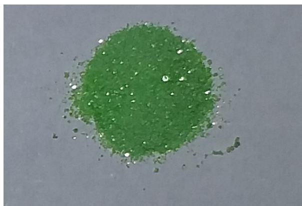
Figura 68. MOF NiCu TMA após lavagem e secagem.
