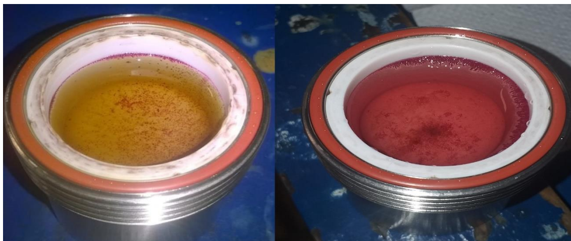
Figura 77. Produtos obtidos após sínteses tentativas utilizando \text{Co}^{2+} e ligantes NDI-py e ácido tereftálico.
