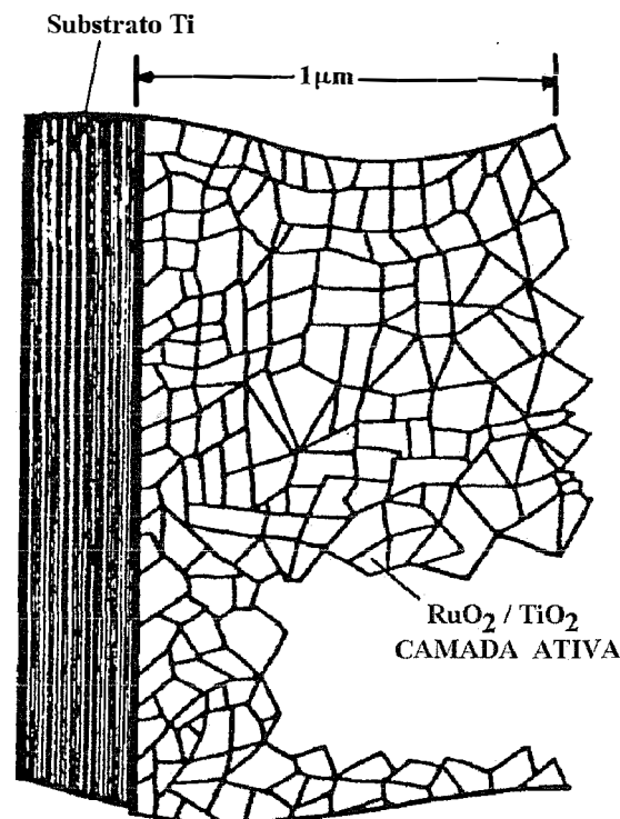
FIGURA 1 - Esquema representativo da camada ativa depositada sobre suporte de Ti. Extraída da referência 143.
