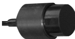
Figura 4.4 - Sonda de ecografia desenvolvida na EESC-USP.
