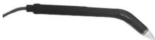
Figura 4.2 - Sonda 2, com frequência de excitação de 11,5 MHz, desenvolvida pelo nosso grupo em conjunto com a UFSCar.
