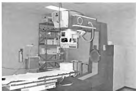
Figura 3.7- Fonte de ^{60}\text{Co} de teleterapia utilizada para irradiar as bolsas de sangue e os dosímetros.
