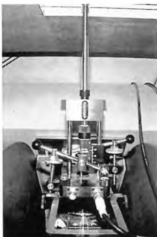
Figura 4.25- Posicionamento da pastilha na cavidade: comprimento da cavidade (19 mm) e linha vermelha em 17mm.
