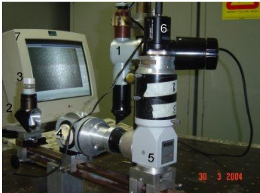
**Figura 45: Foto do Sistema de Microscópio Especular montado em Bancada Óptica**
