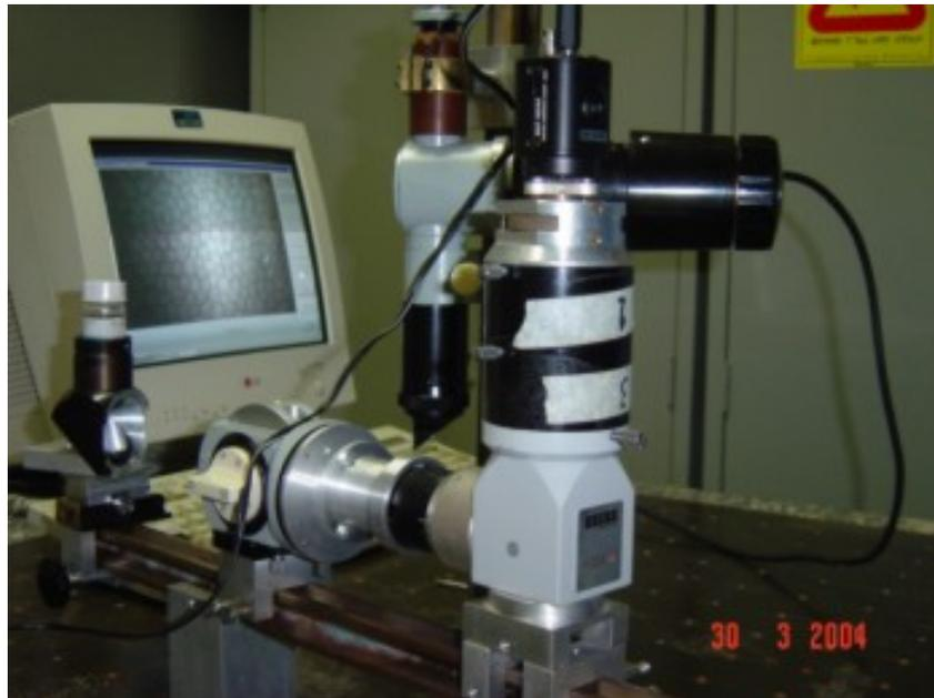
Figura 31: Foto do Microscópio Especular montado em Bancada Óptica
