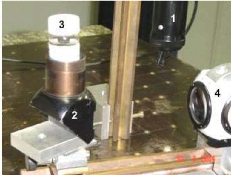
**Figura 46: Foto do Sistema de Microscópio Especular montado em Bancada Óptica, destacando o sistema de iluminação, o suporte para o frasco preservativo, e a objetiva.**
