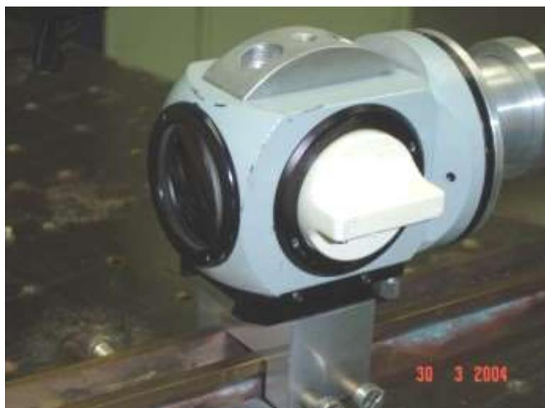
**Figura 47: Foto do Sistema Objetiva/Telescópio Galileano do M.E.**
