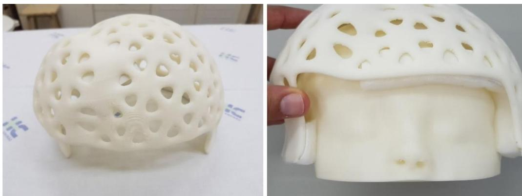
**Figura 24 - Modelos de protetores, desenvolvidos com base na morfologia das cabeças das pacientes recém operadas, utilizando impressão 3D e imagens de RM pós operatórias.**
