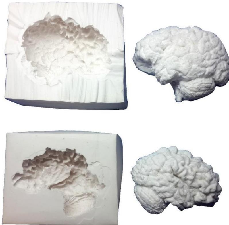
**Figura 2 - À esquerda moldes de silicone obtidos a partir da impressão 3D, em PLA, dos hemisférios cerebrais do paciente (à direita da figura). Os moldes foram preenchidos posteriormente com material simulador.**
