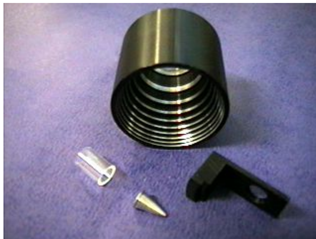
Figura 5.8 - Partes constituintes da mira para o topógrafo corneano para adaptação a microscópios oculares
