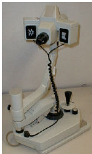
Figura 2.7 - Ceratômetro comercial estilo Javal-Shiotz 11
