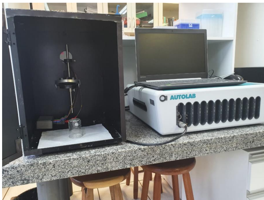
Figura 4.1 – Bancada utilizada para a produção de filmes finos de polianilina em substrato de FTO, contendo uma gaiola de Faraday para construir a célula eletroquímica, um computador e um potenciostato.
