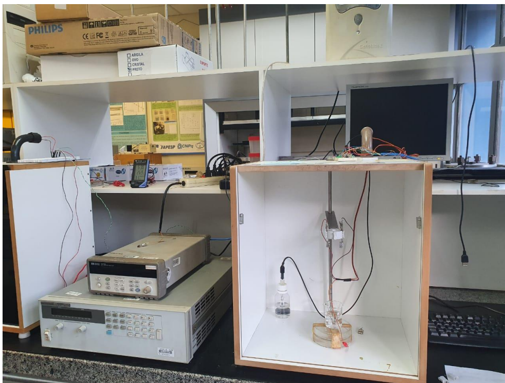
Figura 4.5 – Bancada utilizada para a medida de pH utilizando filmes finos de polianilina em substrato de FTO e o sistema IA-EGFET.
