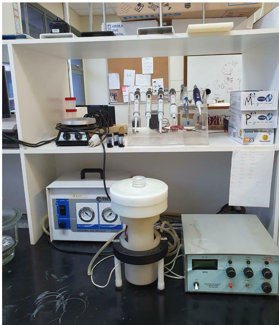
Figura 4.4 – Bancada experimental utilizada para a produção de filmes finos de polianilina por spin coating , contendo o equipamento de spin coating , o motor, a bomba de vácuo e as pipetas utilizadas.
