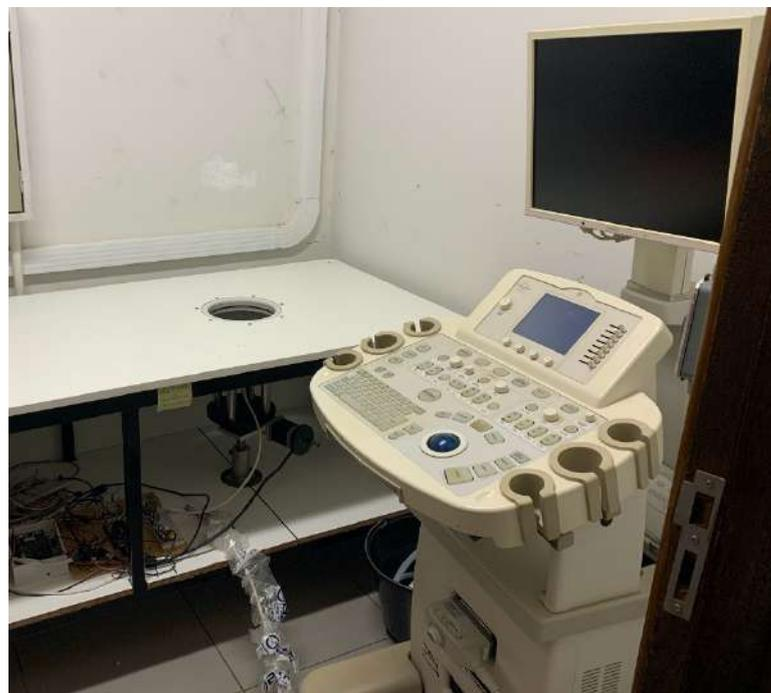
Figura 11- Foto do sistema completo de maca, aparato mecânico e eletrônico, com conexão ao equipamento de ultrassom, para aquisição *in vivo*.
