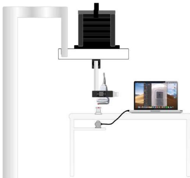
Figura 13- Esquema de representação do sistema de calibração para aquisição simples *in vitro*.
