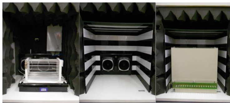
Figura 10. A esquerda, a figura apresenta o conjunto gaiola de contenção/estabilímetro, para registro da resposta de sobressalto. Ao centro as peças de acrílico utilizadas para a mudança do contexto A em B. A direita, a caixa de condicionamento para aplicação dos choques nas patas.
