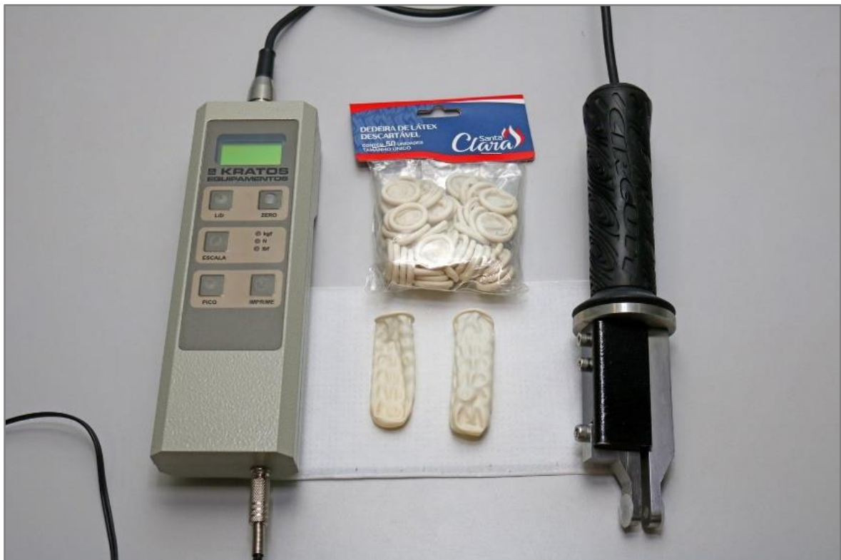
Figura 4 - Dinamômetro digital, modelo IDDK (Kratos, Cotia, SP, Brasil)
