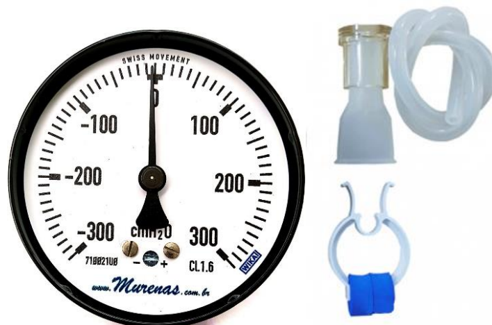
Figura 2 - Equipamento de manovacuometria para avaliar força muscular respiratória
