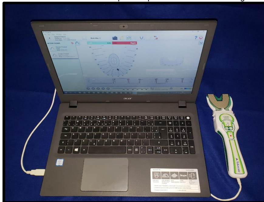
Figura 9 – T-Scan® III conectado ao computador pela entrada USB e a imagem do software
